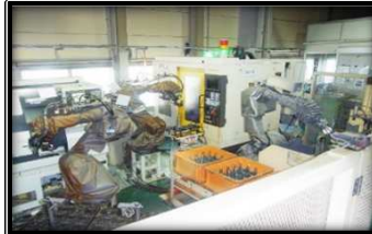
セル加工システム ロボット付旋削&切削+バリ取りマシン
